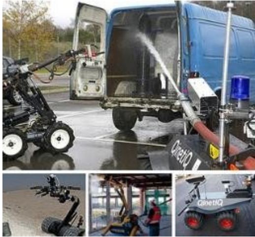
Ilustración 1 - Robots civiles anti incendios apagando el fuego de una camioneta accidentada
