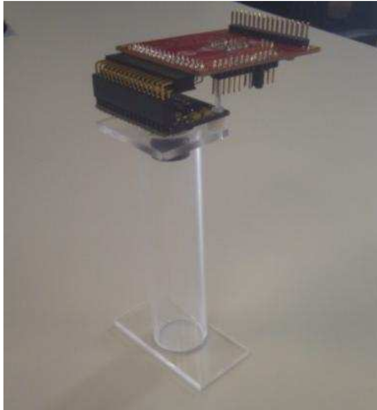
Figura 8.5: Soporte con la cámara instalada.
