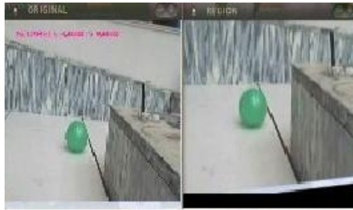
Figura 45: Estabilización en rotación y traslación en y
