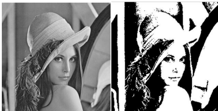
Figura 23: Izquierda imagen en escala de grises, a la derecha binarización de la imagen
