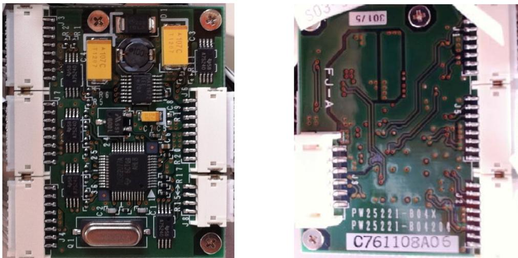
**Figura 33. Placa de control de motores y servos**
