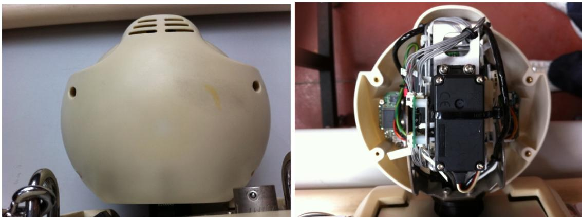
**Figura 163. Desmontaje de la carcasa trasera que cubre la cabeza del robot.**
