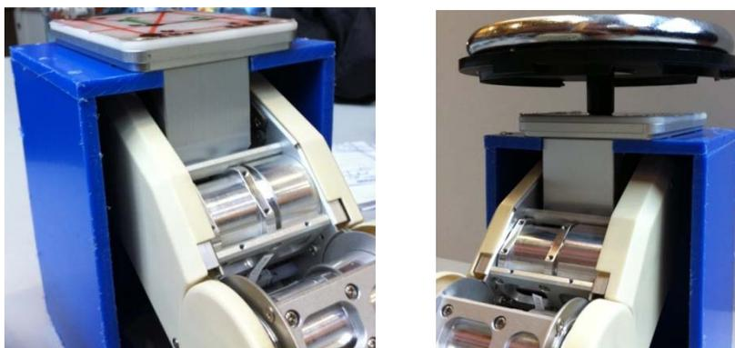
**Figura 85. Bloqueo de tobillo con plataforma y ejemplo de sujeción de pesas**
