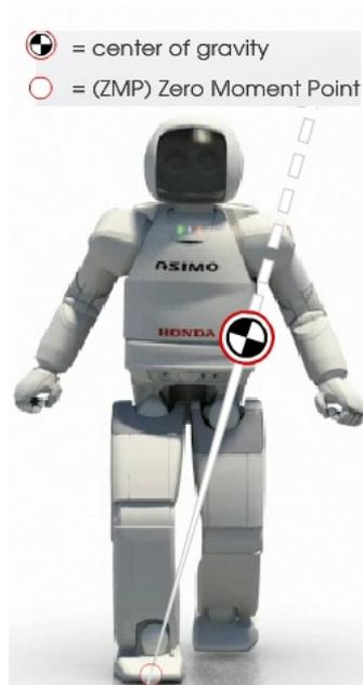
**Figura 6. Localización del centro de gravedad y del ZMP de ASIMO**
