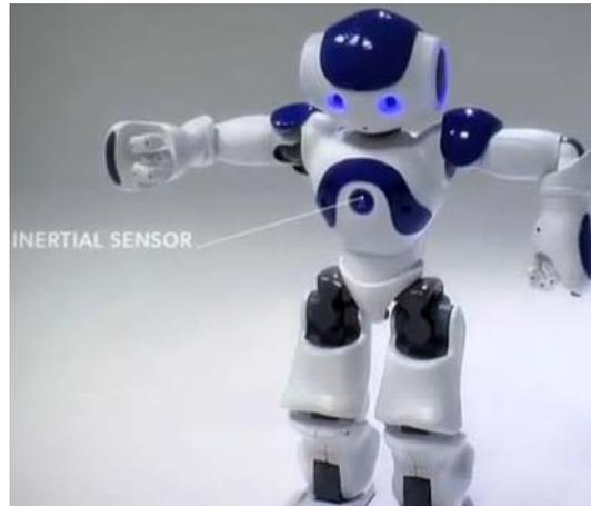
**Figura 13. Acelerómetros y giróscopos en NAO**
