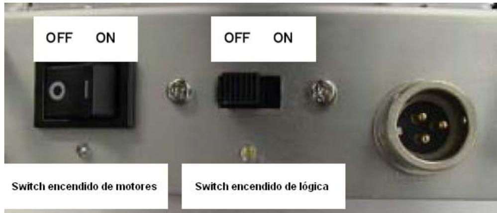
**Figura 41. Interruptores de lógica y motores**
