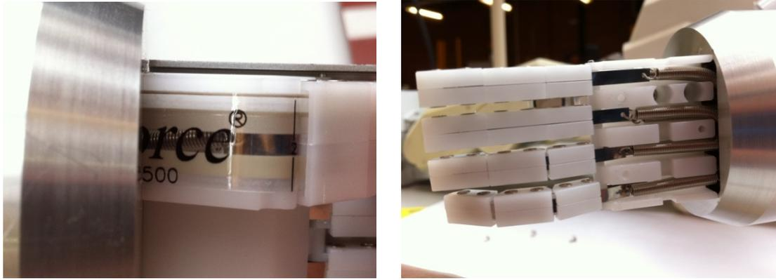
**Figura 86. Anverso y reverso de la mano. Vista del sensor FSR y los actuadores de dedos**
