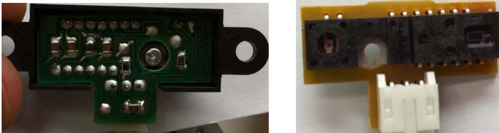
**Figura 167. Circuito impreso interior del sensor infrarrojo**
