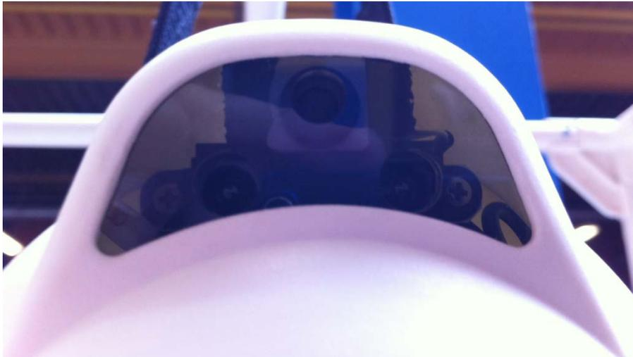
**Figura 162. Ubicación del sensor infrarrojo**
