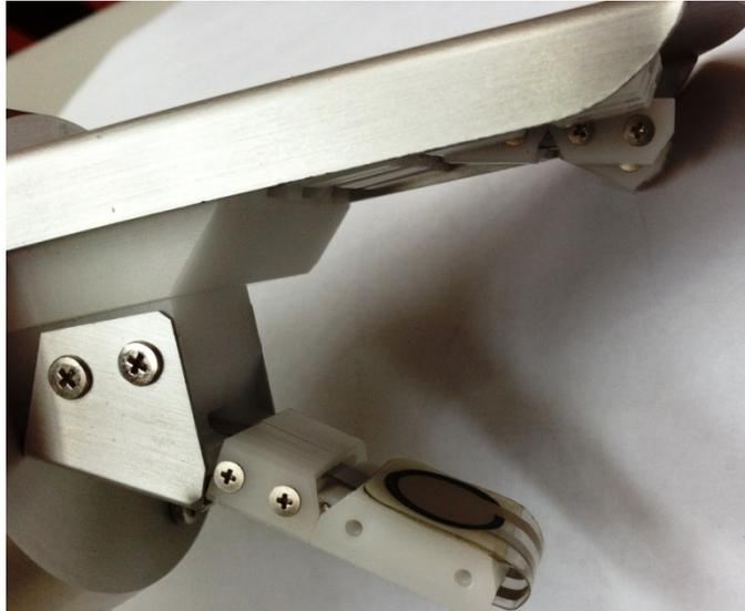
**Figura 156. Detalle del sensor FSR para su desmontaje**
